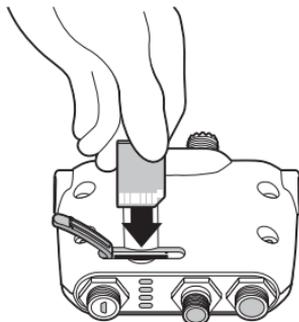
*Ilustración 13*      *Introducción de una tarjeta de memoria*
