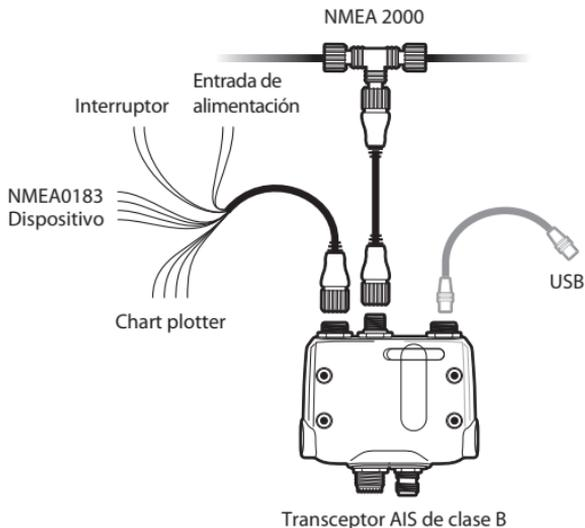
*Ilustración 3*      *Conexiones eléctricas del Transceptor AIS*
