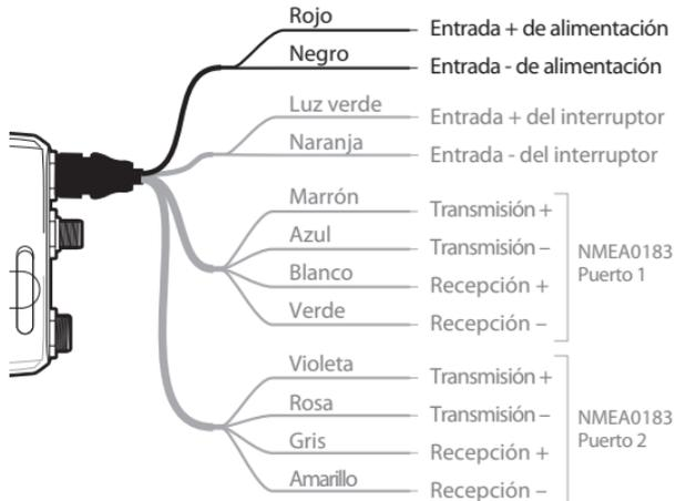
*Ilustración 11 Conexión de la fuente de alimentación*
