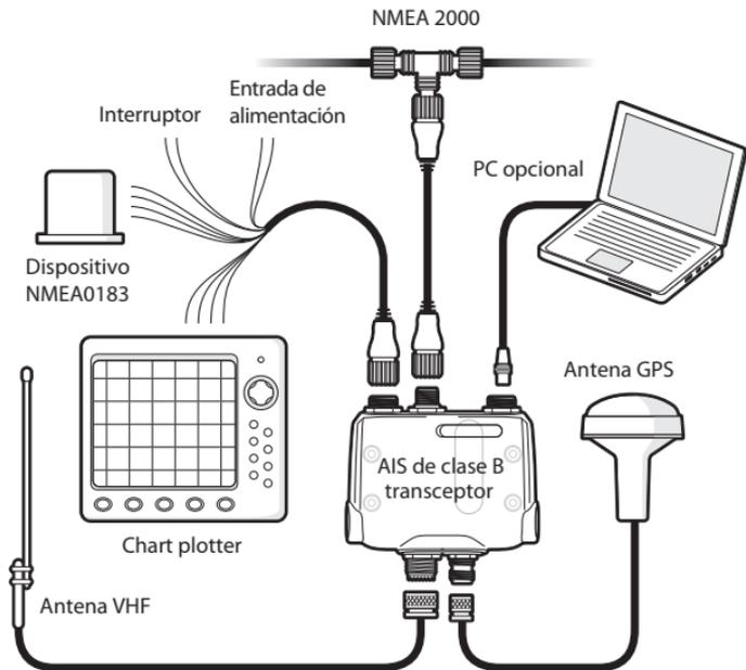
Ilustración 4 Configuración de instalación típica
