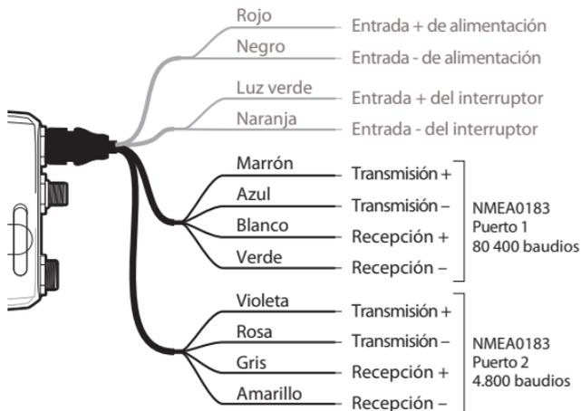
Ilustración 10 Conexión al puerto de datos NMEA0183
