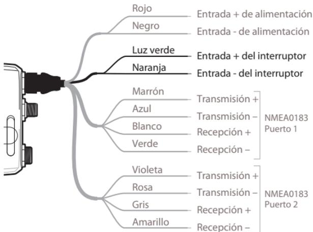
Ilustración 9 Conexión de un interruptor externo
