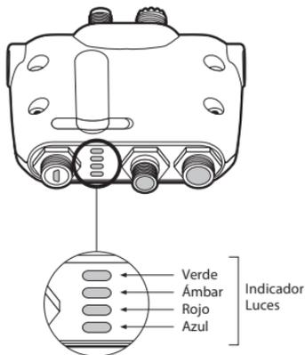
*Ilustración 14 Ubicación del indicador en la unidad del Transceptor AIS*
