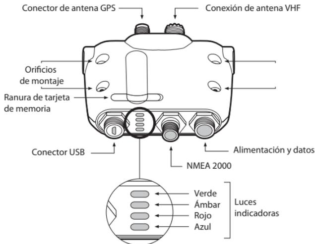
Ilustración 2 Vista general del Transceptor AIS
