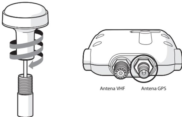
Ilustración 6 Montaje y conexión de la antena GPS
